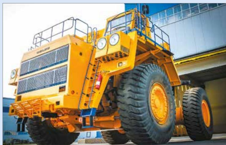
Угольная компания «Южный Кузбасс» (входит в группу «Мечел») выпустила на линию 4 карьерных самосвала БелАЗ грузоподъемностью 220 тонн. Благодаря новой технике предприятие планирует нарастить объемы вскрыши и добычи до конца года.
