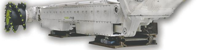
ная мощность комбайна составляет 880 кВт, максимальная рабочая скорость — до 11,4 метров в минуту. Очистной комбайн оснащен системами диагностики и радиоуправления, что позволяет следить за работой техники с поверхности в режиме реального времени. Управлять комбайном можно как с пульта, так и в ручном режиме.
