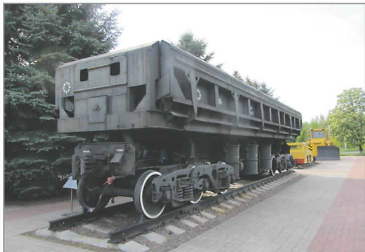
Волчанский механический завод (входит в Уралвагонзавод) впервые изготовил и отгрузил заказчику два серийных образца вагона-самосвала (думпкара) модели 33-9985 грузоподъемностью 105 т.
